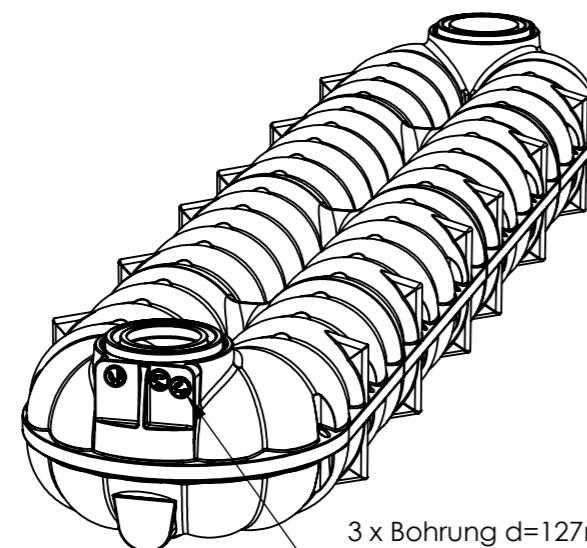
3 x Bohrung d=127mm
